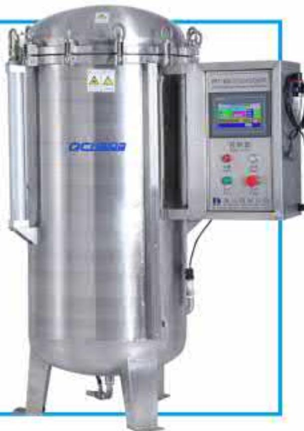
本产品适用于在运输、贮存或使用期间可能遭受浸水的电工电子产品的试验方法。考核电工电子产品外壳和遮蔽物等密封件在浸水试验后能否保证设备和元件良好的试验。
