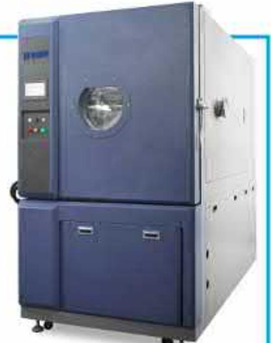
本产品用于模拟不同海拔环境下的测试环境，这对于压力和真空条件更为恶劣的国防和航天应用尤为重要。应用领域：包括航空、航天、通信、电子、电器等。试验目的：保证产品或材料在不同高度可能遇到的最大质量可靠性和安全性。
