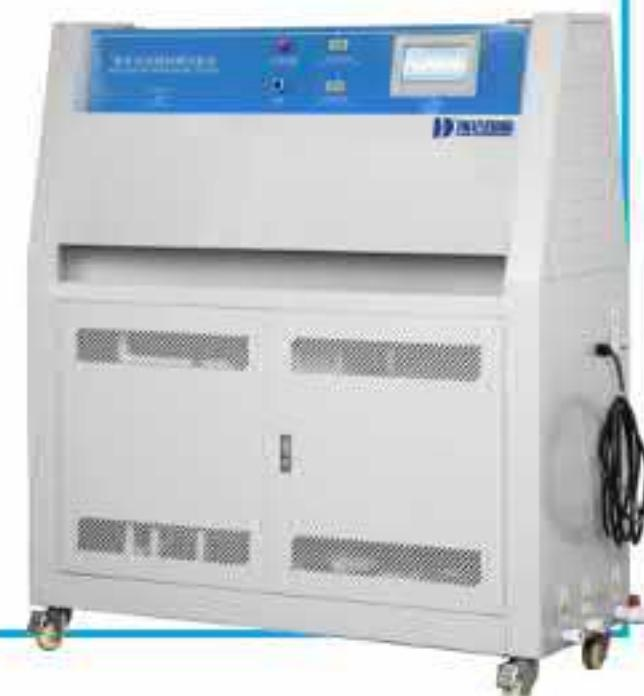
本产品可模拟太阳光的紫外光谱，程序设定温度、光照及降雨等条件。此设备用于测试在光照条件下对产品造成的不同类型的损害，如变色、龟裂、剥落、强度下降、氧化等。耐光能力或单一耐候能力减弱或失效，从而广泛用于对材料耐气候性能的评价。
